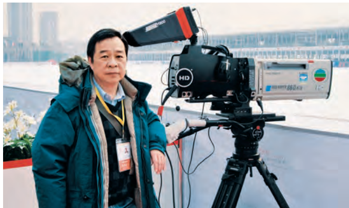
圖中一秒一千格的超高速攝影機用於捕捉最精細動作，早前拍攝雪地馬球賽也有使用。
